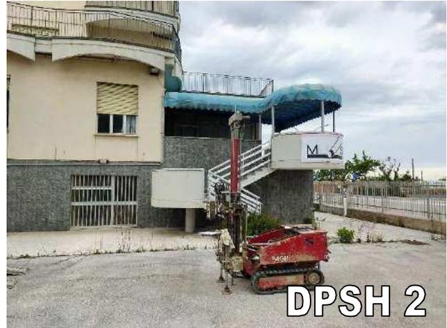
**INDAGINE GEOTECNICA MEDIANTE PROVE PENETROMETRICHE
