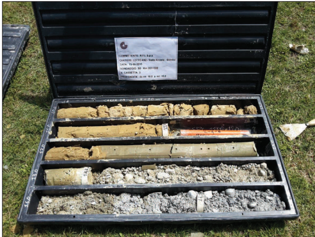
Sondaggio S8 – cassetta 3 – da 10 a 15 m di profondità
