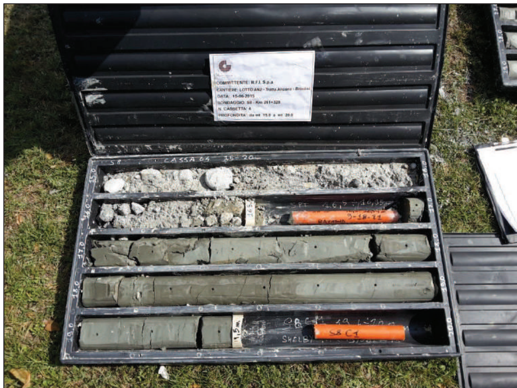
Sondaggio S8 – cassetta 4 – da 15 a 20 m di profondità
