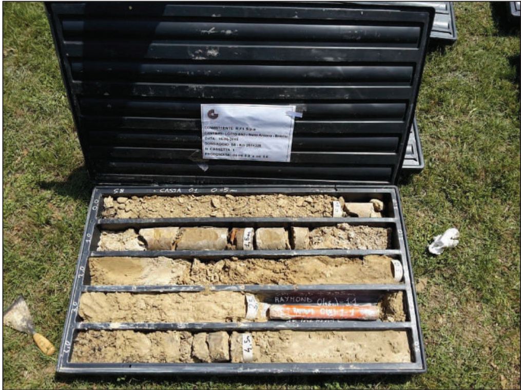
Sondaggio S8 – cassetta 1 – da 0 a 5 m di profondità
