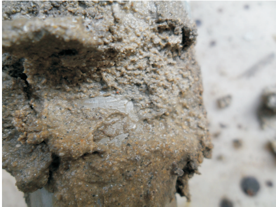
foto 3-4: Sabbie talora sature riscontrate sulle aste penetrometriche dopo l'esecuzione delle prove in situ
