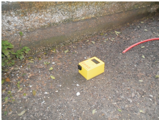
foto 5: esecuzione rilievo sismico passivo con tecnica HSRV e registrazione mediante tromografo digitale
