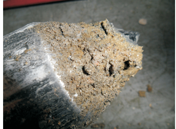
foto 3-4: Sabbie talora sature riscontrate sulle aste penetrometriche dopo l'esecuzione delle prove in situ
