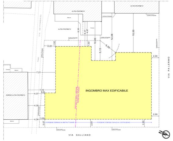
PLANIMETRIA DEGLI EDIFICI AI FINI DELLA VERIFICA DELLE DISTANZE DI PROGETTO SCALA 1:200
