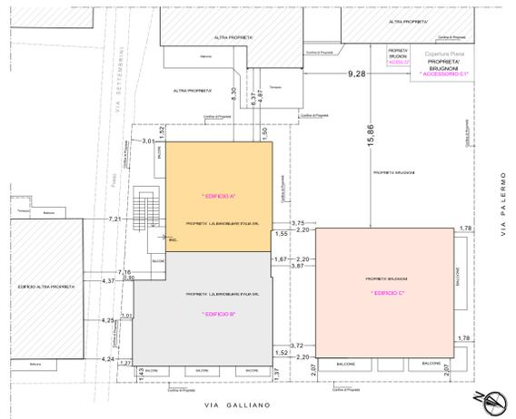
PLANIMETRIA DEGLI EDIFICI AI FINI DELLA VERIFICA DELLE DISTANZE ESISTENTI SCALA 1:200
