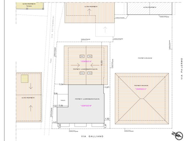
PLANIMETRIA DEGLI EDIFICI AI FINI DELLA VERIFICA DELLE DISTANZE ESISTENTI SCALA 1:200
