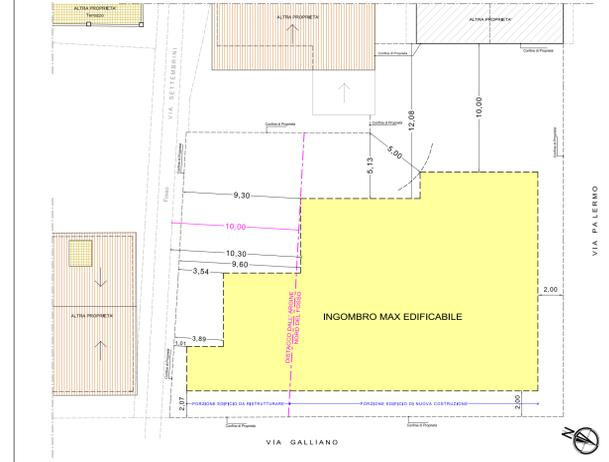
PLANIMETRIA DEGLI EDIFICI AI FINI DELLA VERIFICA DELLE DISTANZE DI PROGETTO SCALA 1:200
