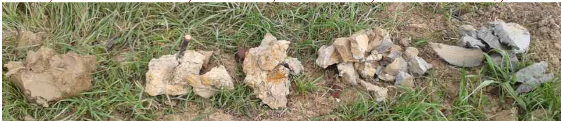
Foto 2 : Stratigrafia del sondaggio S1. Da sinistra a destra a) Limo argilloso sabbioso; b) Argilla limo-sabbiosa; c) Argilla limosa alterata e fratturata; d) Argilla limosa alterata; e) Argilla limosa integra.
