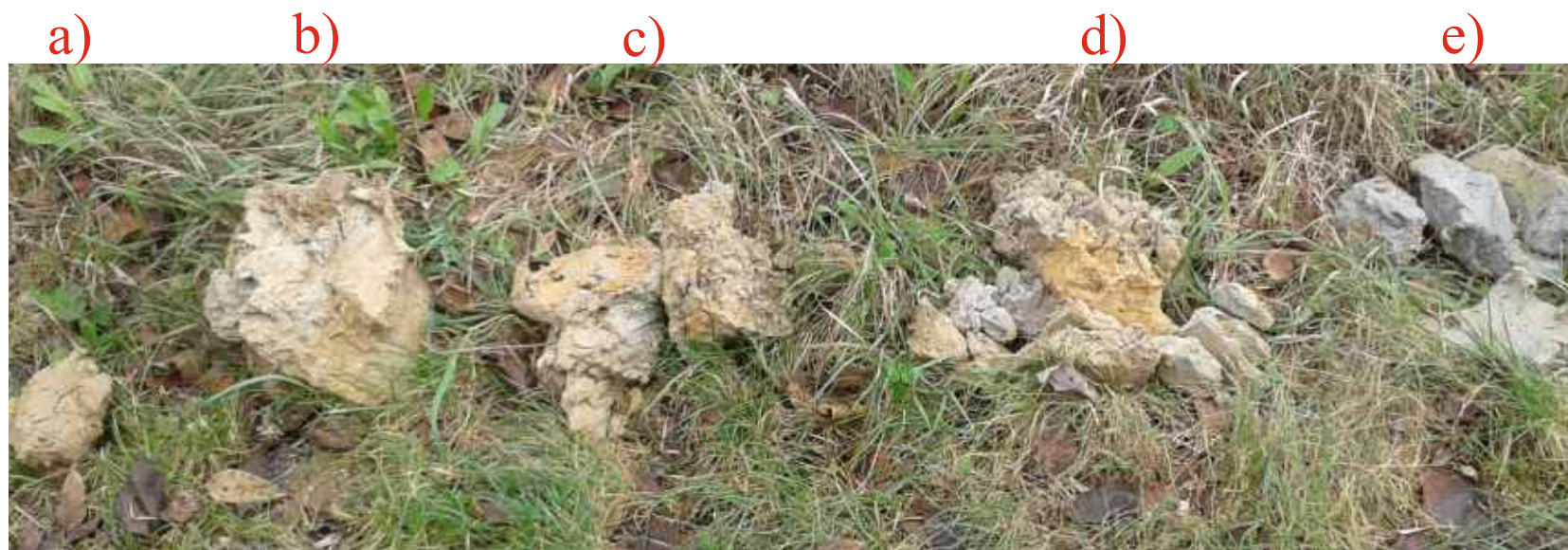
Foto 4 : Stratigrafia del sondaggio S2. Da sinistra a destra a) Limo argilloso sabbioso; b) Argilla limo-sabbiosa; c) Argilla limosa alterata e fratturata; d) Argilla limosa alterata; e) Argilla limosa integra.
